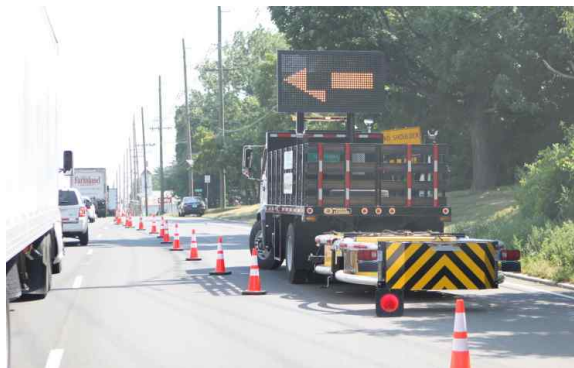
<그림 5.12> 국외 트럭 장착 완충시설(TMA) 예
